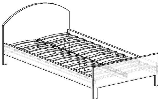
1. Установить царги (поз.3, поз.4) в зацепы спинки (поз.1, поз.2), так чтобы опорный брусок царги был расположен внутри кровати.
