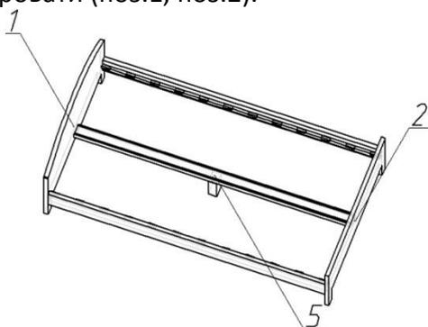
4. Одной стороной ламели (поз.7) установить в латодержатели (поз.8), которые предустановлены на опорных брусках царг (поз.3, поз.4), второй закрепить на среднике (поз.5), предварительно установив латодержатели (поз.8).
