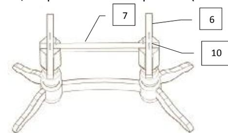
3. Поставить столешницу (поз. 1) на подстольные планки (поз. 6) так, чтобы она стояла ровно относительно всех 4-х сторон. Вкрутить саморезы (поз 10), как показано на рисунке.
